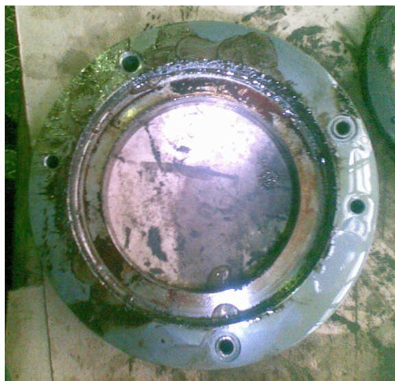
Рисунок 7 - Камера уплотнения штока 4 ступени после работы без смазки
